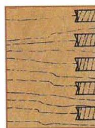
Рис. 6. Шипы пробной детали срезают на скос... Рис. 7. ... и используют в качестве «пробок» для вклеивания в отверстия шипового соединения.
