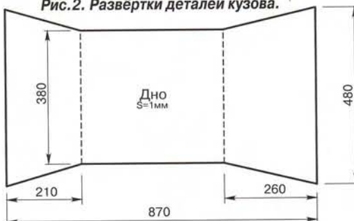
Рис. 2. Развёртки деталей кузова.
