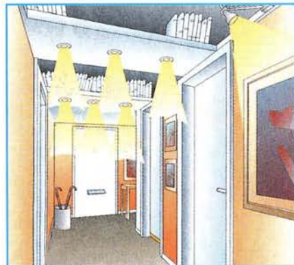
Прихожая. Мягкое общее освещение создаёт в помещении приветливую атмосферу, чему способствуют и местные источники света, освещающие картины.
