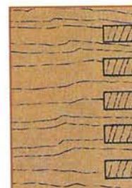
Рис. 9. Режущие кромки зубьев диска для продольного пиления заточены под прямым углом к его боковым сторонам, и дно прорези получается плоским.
