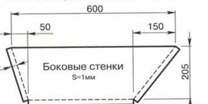
Рис. 2. Развёртки деталей кузова.
